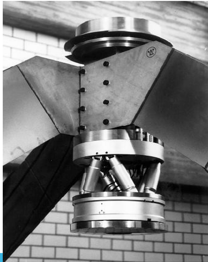
英国赤外線4m望遠鏡(UKIRT)の 30cmティップティルト副鏡
