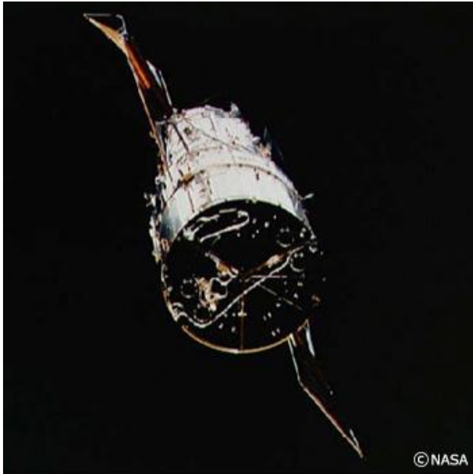
Hubble Space Telescope (ハッブル宇宙望遠鏡) (1990～) 直径2.4mの望遠鏡 11 t
